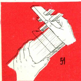
namento e di squadratura dei pezzi costituenti le fiancate trasversali vanno effettuate in modo analogo a quelle relative alle fiancate longitudinali.
